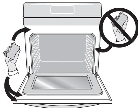
Figure 6 : Nettoyer la partie autour du joint de la porte du four
