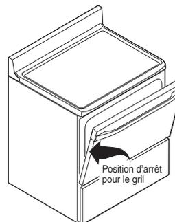
Figure 13 : La porte du four ouverte jusqu'à la position d'arrêt du gril
