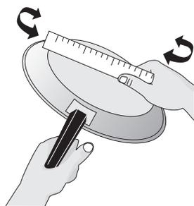
Vérifier sa planéité en faisant tourner une règle sur le fond de la casserole (voir [Figure 1](#)). Les ustensiles de cuisine doivent avoir des fonds plats qui sont bien en contact avec toute la surface de l'élément de chauffage (voir [Figure 2](#)).
