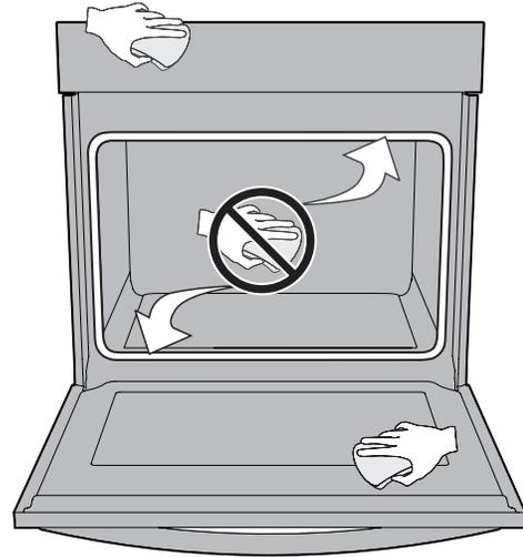
**Figura 17: Limpie alrededor de la junta de la puerta del horno.**
