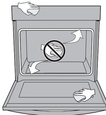
Figure 16: Nettoyer le pourtour du joint de la porte du four
