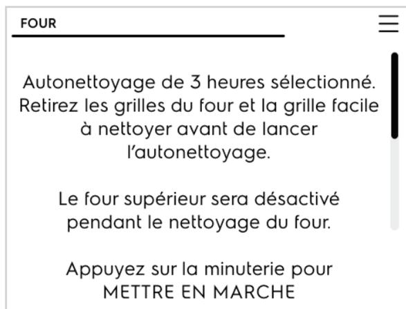
Lorsque le four est réglé au cycle d'autonettoyage, le loquet motorisé de la porte commencera à verrouiller la porte du four. N'ouvrez pas la porte du four lorsque le moteur de verrouillage est en marche ou lorsque des indicateurs de verrouillage ou des messages sont affichés. La porte du four sera complètement verrouillée après environ 15 secondes. Lorsque la porte est verrouillée, NETTOYAGE s'affiche pour indiquer que le four va commencer le processus d'autonettoyage.
