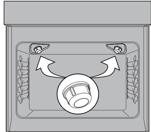
**Figure 20: Lumière halogène du four**
