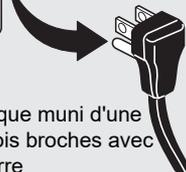
Fil électrique muni d'une fiche à trois broches avec mise à terre
