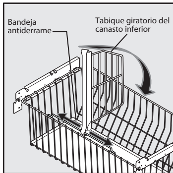
Tabique giratorio de canasto inferior (algunos modelos)
