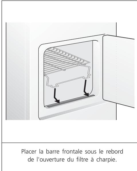
Placer la barre frontale sous le rebord de l'ouverture du filtre à charpie.
