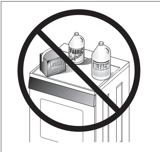
Ne ranger, ni poser en aucun temps des produits à lessive, tels que du détergent, de l'assouplissant et du javellisant, sur le dessus de la sècheuse. Ces produits peuvent endommager le fini ou les commandes de la sècheuse.
