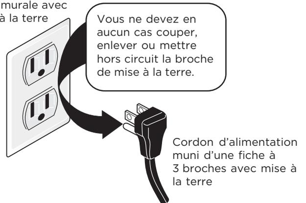
Cet appareil est muni d'une fiche à trois broches avec mise à la terre pour assurer votre protection contre les chocs électriques. Cette fiche doit être branchée directement dans une prise correctement mise à la terre. N'enlevez pas la broche de mise à la terre de cette fiche.
