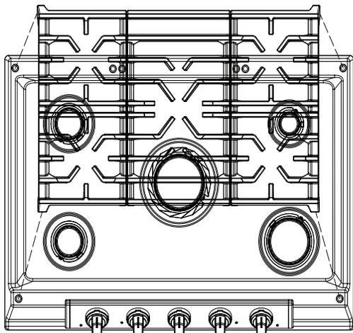
Figure 5: Installation correcte des grilles
