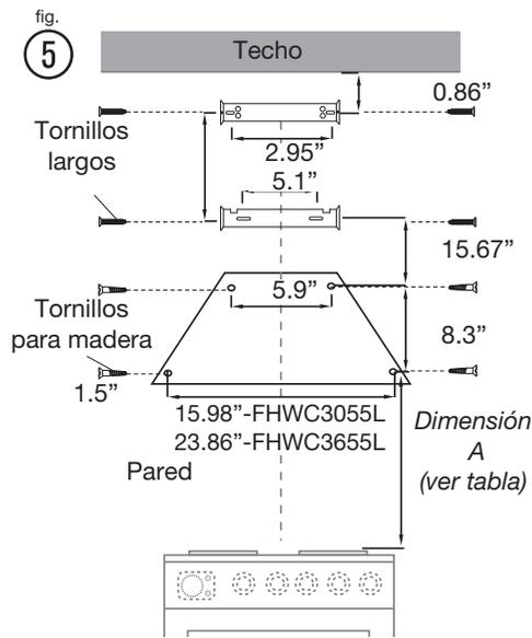
**Distancia deseada de la campana extractora sobre una placa de cocina de 36" (91,44 cm) de alto.**
