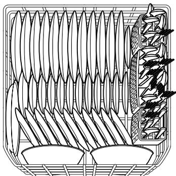
Patrón de carga normal con 12 ajustado de posiciones. (Pliegue los dientes)
