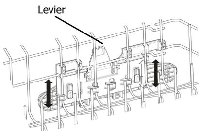
Pour réduire la partie supérieur du rack, appuyez sur le levier et poussez vers le bas sur le rack.
