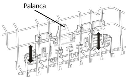
Para bajar el bastidor superior, presione la palanca y empuje hacia abajo en el rack.
