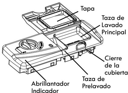
Nota: Si la cubierta está cerrada en la copa de lavado principal, abrir presionando el cierre de la cubierta.
