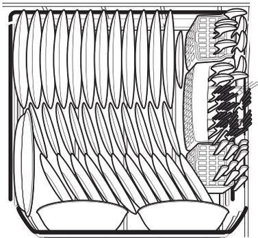
Patrón de carga normal con 12 ajustes de posiciones. (Dientes fijos).
