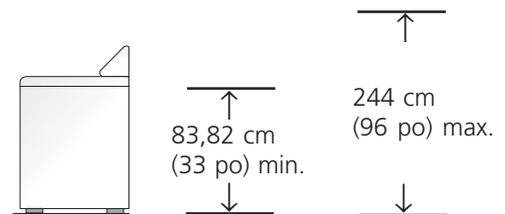
technicien qualifié d'installer un tuyau plus long, n° de pièce 131461201. Pour les systèmes de vidange au sol, installez un ensemble de siphon, n° de pièce 5377678100. Les deux pièces sont disponibles chez un distributeur de pièces de rechange autorisé.
