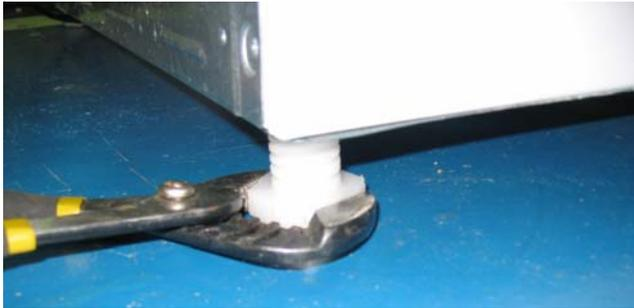
Appuyez des coins et des côtés alternatifs et sentez pour le plus léger mouvement. Ajustez la jambe appropriée ainsi la laveuse est PLEINE sur le plancher sur CHACUNE DES quatre jambes. Gardez la prolongation de mise à
