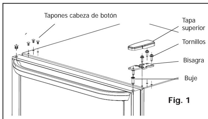
8. Coloque la esquina izquierda inferior de la puerta en la bisagra inferior, luego instale la bisagra superior en el gabinete. Asegúrese de que la puerta esté nivelada y cierre correctamente contra el gabinete, luego ajuste bien los tres tornillos. Vea la Figura 7. Recupere la tapa superior en la bisagra.
