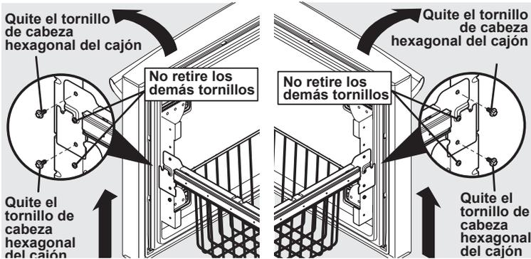
2. Si las juntas no están selladas, abra el cajón y afloje ligeramente cuatro (4) tornillos del cajón (dos (2) de cada lado) para permitir rotar al cajón.
