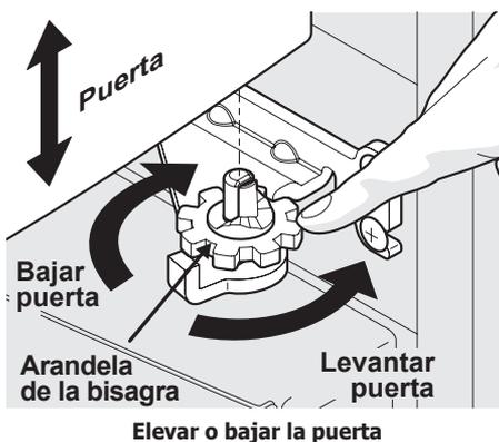
5. Vuelva a ajustar el tornillo, verificando que esté entre los rayos de la arandela ajustada. El tornillo no estará ajustado, simplemente insértelo hasta que esté a nivel con la bisagra.
