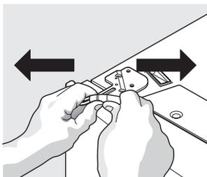
3. Suelte el tubo de agua del conector ubicado detrás del refrigerador y tire del tubo hacia el frente de la unidad. El conector se suelta al presionar hacia adentro en el manguito exterior mientras empuja el tubo hacia el conector y, mientras sigue sujetando el manguito, tire del tubo.
