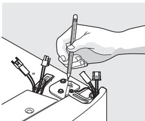
2. Desconecte el armés sujetando ambos lados del conector con firmeza, presione el pestillo y separe. Quite los dos (2) tornillos de la bisagra superior. Levante la puerta fuera de la bisagra inferior y guárdela.
