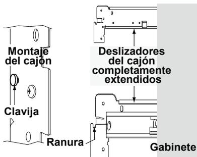
2. Vuelva a colocar cuatro (4) tornillos del cajón (dos (2) por lado), ajuste y cierre el cajón (C).
