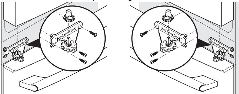
Cuando ambas puertas estén colocadas, verifique que estén alineadas entre sí y niveladas (consulte la sección de "Instalación" para más información) y vuelva a colocar la cubierta de la bisagra superior.
