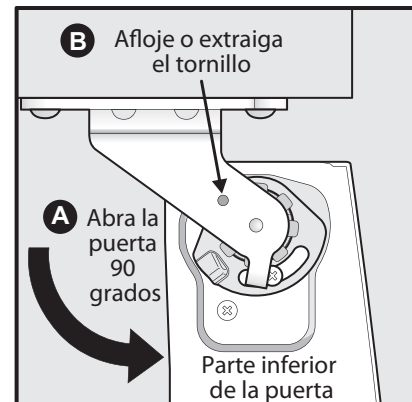
Aflojar/quitar tornillo (modelos selectos)
