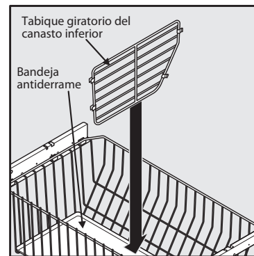
Tabique del canasto inferior y bandeja antiderrame
