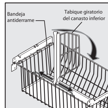
Tabique giratorio de canasto inferior (algunos modelos)
