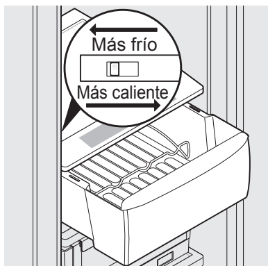
Cajón de enfriamiento con control de temperatura
