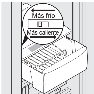
Cajón de enfriamiento con control de temperatura
