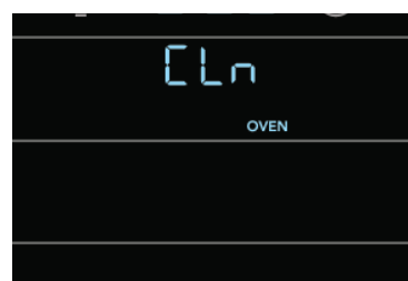
Figure 31 : L'icône Clean lock (Verrouillage nettoyage) clignote lorsque la porte se déverrouille
