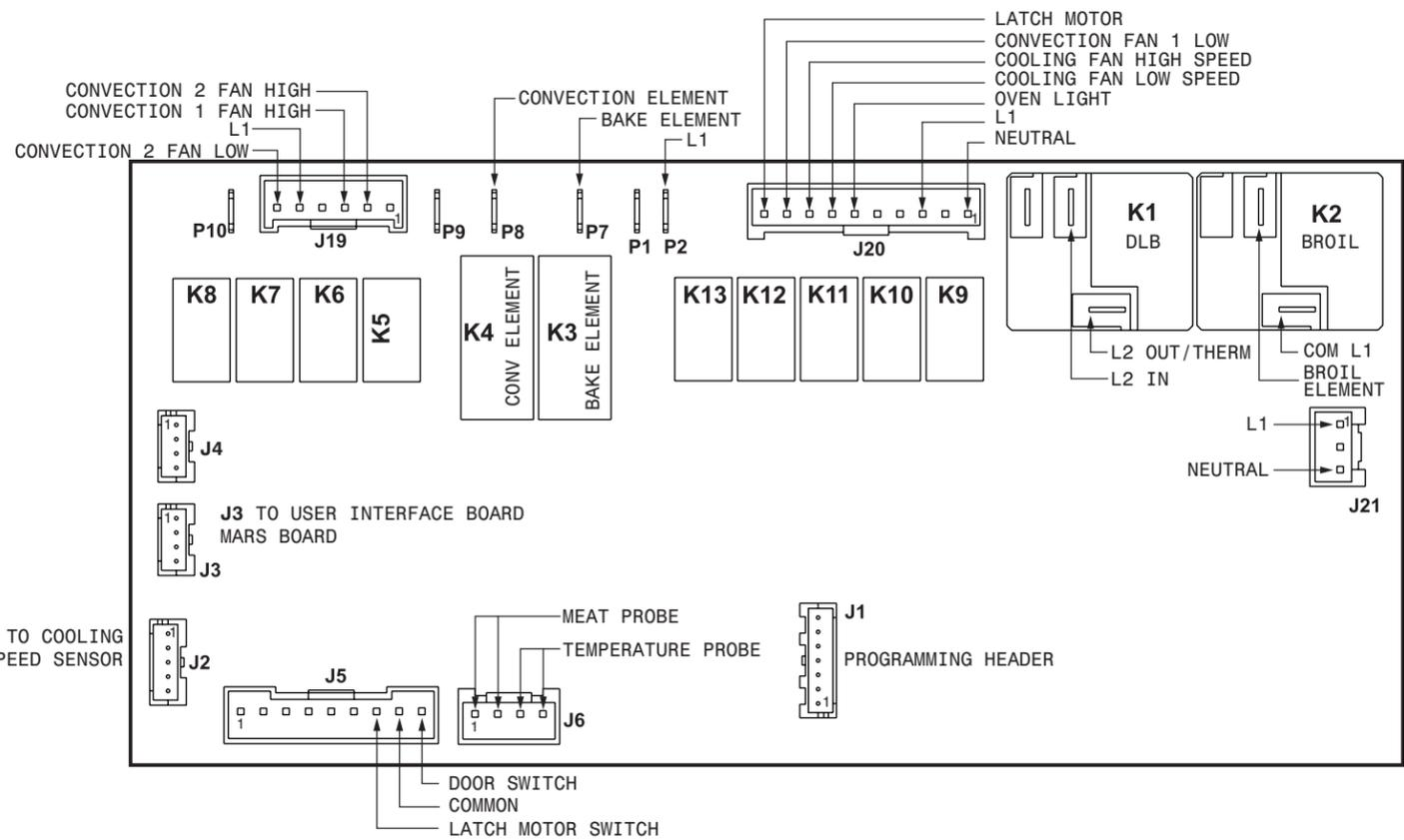
SINGLE WALL OVEN CIRCUIT // CIRCUITO DEL HORNO DOBLE //
