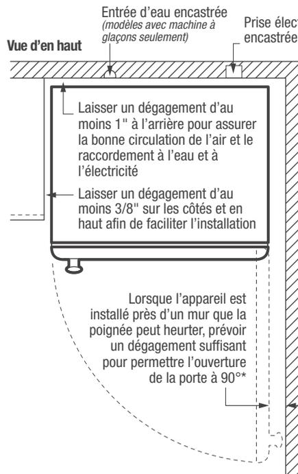
\* Lorsque le réfrigérateur est installé près d'un mur, d'une armoire ou d'un autre appareil qui dépasse le bord avant du réfrigérateur, un dégagement minimal de 20" est recommandé pour permettre une ouverture optimale de la porte à 140°, pour l'accès ou le retrait complet du bac à fruits et à légumes. (Le dégagement minimal absolu de 3" permettra l'ouverture de la porte à 90° SEULEMENT, ce qui limitera l'accès au bac à fruits et à légumes, ainsi que son retrait.)
