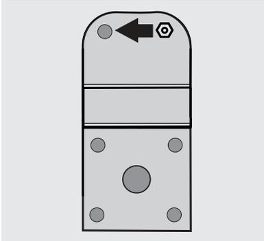
8. Desatornille la pata de nivelación ajustable izquierda.
