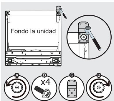
7. Desatornille e introduzca el pasador de la bisagra en el lado opuesto de la bisagra inferior utilizando una llave ajustable.
