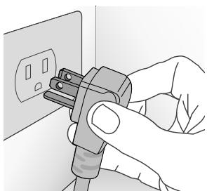
El aparato funciona a 115 V CA, 60 Hz y está equipado con un cable de alimentación con conexión a tierra de 3 clavijas, el cual debe conectarse a la toma de pared con conexión a tierra de 3 clavijas (15 amperios) correspondiente.
