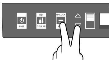
**Para evitar la modificación involuntaria de los ajustes, el teclado se bloquea en automático transcurrido un cierto tiempo y en la pantalla aparece el mensaje "keypad locked".**
