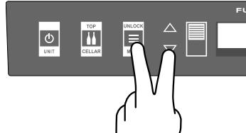
**Om ongewenste wijziging van de instellingen te voorkomen, blokkeert het toetsenbord automatisch na het verstrijken van een bepaalde periode en verschijnt op het display de melding "keypad locked".**
