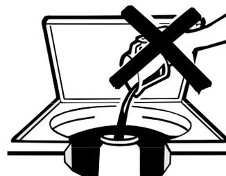
No vierta nada en el agitador si se retira la tapa del agitador o el dosificador.
