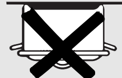
Les récipients dont les fonds sont bombés, courbés, striés ou voilés ne sont pas recommandés.
