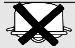
Verifiez, à l'aide d'une règle, que les fonds des récipients sont plats.
