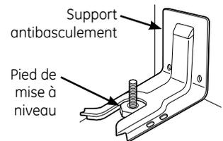
Afin de réduire les risques de renversement, la cuisinière doit être fixée correctement au moyen du support antibasculement.
