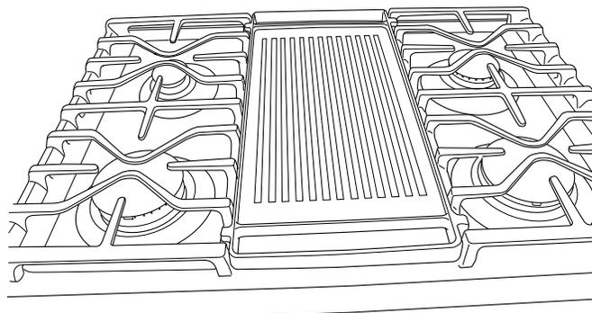
Remplacez la grille centrale (le cas échéant) par la plaque chauffante réversible en fonte prétraitée.
