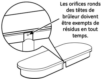
Pour un bon allumage, veillez à ce que le petit orifice de la section qui se pose sur l'électrode ne soit pas obstrué. Pour le désobstruer, une aiguille à coudre ou un lien torsadé suffisent.
