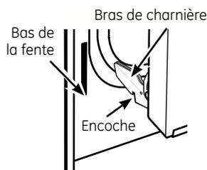
Faites reposer l'encoche sur le bas de la fente de la charnière
