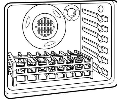
Une fois que les grilles de brûleur ont été placées dans le four, activez le cycle d'autonettoyage en suivant les instructions de la section « Nettoyage du four ».
