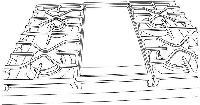
Remplacez la grille centrale (le cas échéant) par la plaque chauffante antiadhésive en aluminium.
