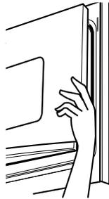
**D11** En maintenant la porte à la position d'enlèvement, c'est-à-dire à mi-chemin entre la position de fermeture et la position de cuisson sous le gril (Broil), placez l'encoche du bras de charnière dans le bord inférieur de la fente de la charnière. L'encoche doit être bien insérée dans le bas de la fente.
