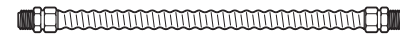
Tubería flexible de gas aprobada por CSA de 3/8" Min. ID, Conexión NPT de 1/2", Longitud máxima de 3 pies (sólo Massachusetts)
