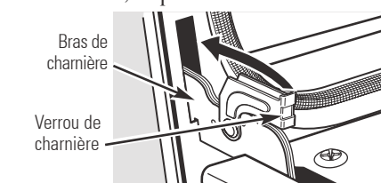
Poussez les verrous de la charnière vers le haut pour verrouiller.
