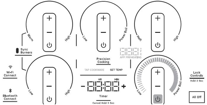
5. La table de cuisson affichera la température cible et le préchauffage. Lorsque la légende **Preheating (Préchauffage)** disparaît, cela signifie que la température cible a été atteinte.
