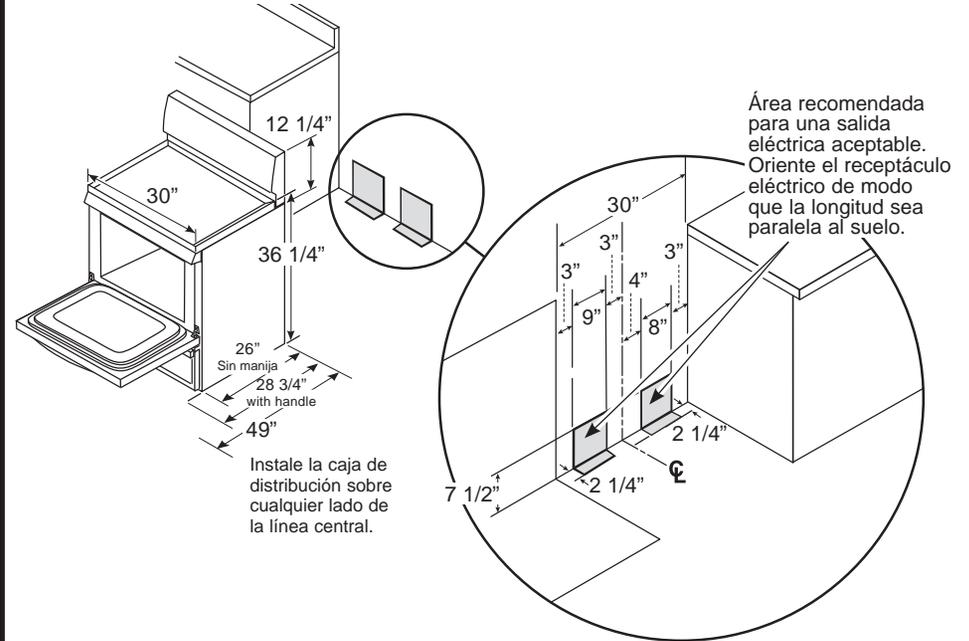
**NOTA:** Utilice un cable de energía de 4' para evitar una interferencia con el cajón de almacenamiento. Los cables de energía de 4 1/2' a 6' de largo pueden tener que cubrirse para poder cerrar el cajón correctamente.
