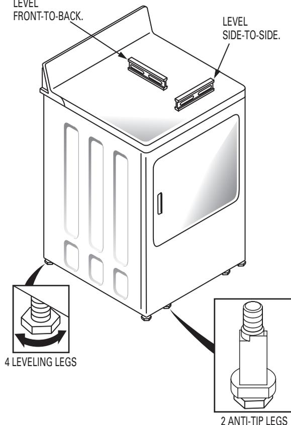
STAND THE DRYER UPRIGHT NEAR THE FINAL LOCATION AND ADJUST THE 4 LEVELING LEGS TO MATCH THE HEIGHT OF YOUR WASHER. ADJUST THE 2 ANTI-TIP LEGS TO CONTACT THE FLOOR.
