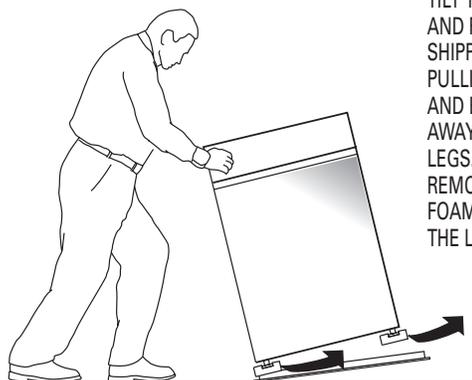
TILT THE DRYER SIDWAYS AND REMOVE THE FOAM SHIPPING PADS BY PULLING AT THE SIDES AND BREAKING THEM AWAY FROM THE DRYER LEGS. BE SURE TO REMOVE ALL OF THE FOAM PIECES AROUND THE LEGS.
