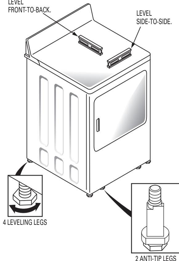
STAND THE DRYER UPRIGHT NEAR THE FINAL LOCATION AND ADJUST THE 4 LEVELING LEGS TO MATCH THE HEIGHT OF YOUR WASHER. ADJUST THE 2 ANTI-TIP LEGS TO CONTACT THE FLOOR.
