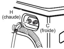
4. Si les rondelles grillagées pour flexibles ne sont pas déjà insérées dans les flexibles d'admission d'eau, insérez-les dans les extrémités libres des flexibles d'eau CHAUDE et FROIDE en orientant la face bombée vers le robinet.
