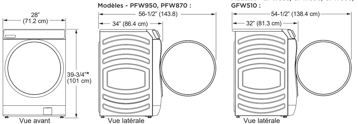
\*Avec pieds de nivellement rétractés : 39-3/4 (101 cm). / Avec pieds de nivellement complètement sortis : 40-5/8 (103.1 cm).
