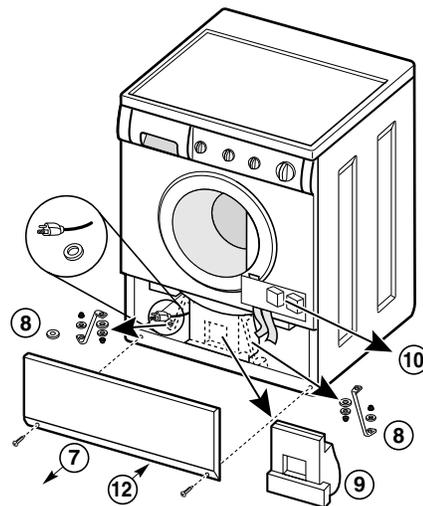
11. À l'arrière de la laveuse, extraire prudemment le cordon d'alimentation à travers le trou de la tôle arrière.
