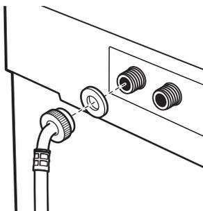
4. Connecter les tuyaux d'alimentation sur les raccords d'entrée d'eau CHAUDE et d'eau FROIDE; serrer à la main; serrer ensuite de 2/3 de tour avec une pince. Ouvrir les robinets; inspecter pour rechercher les fuites d'eau.
