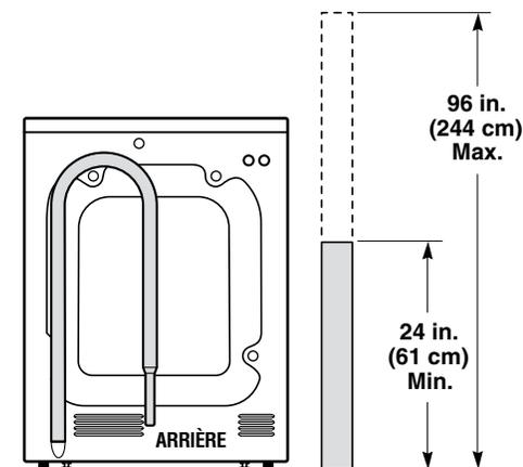
**REMARQUE :** Le tuyau de vidange flexible connecté à la laveuse est assez long pour qu'on puisse l'introduire dans une canalisation verticale dont l'orifice est à 58 po (147 cm) du sol. Si la canalisation verticale est plus haute, contacter un distributeur de pièces agréé. Si la hauteur de la canalisation verticale est inférieure à 24 po (61 cm), installer un dispositif brise-siphon (disponible dans toute quincaillerie locale).
