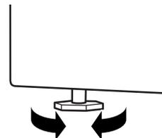
**REMARQUE :** Minimiser la longueur de déploiement des pieds pour minimiser les vibrations. La laveuse vibrera d'autant plus que la longueur de déploiement des pieds est plus grande.
