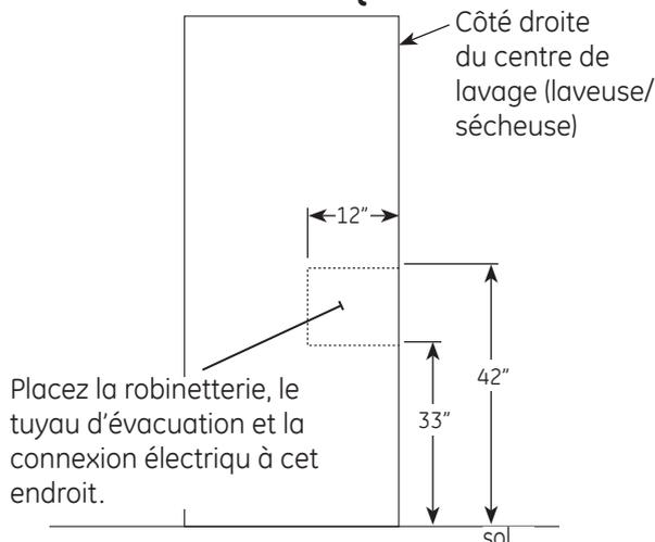
Placez la robinetterie, le tuyau d'évacuation et la connexion électrique à cet endroit.
