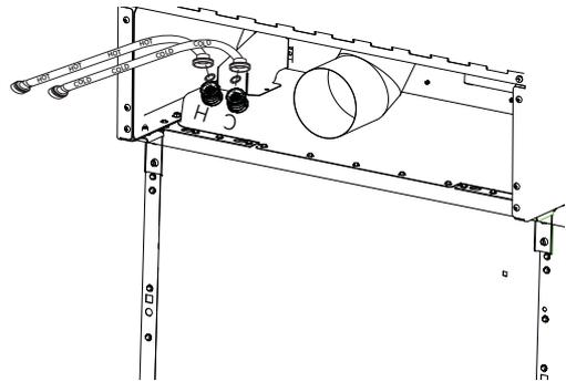
Installez si nécessaire les joints en caoutchouc à l'extrémité de l'arrivée d'eau chaude sur la machine. Introduisez le tuyau d'eau sur le branchement marqué de la lettre C dans le coin en haut de la machine. Serrez à la main, et ajoutez 1/8 de tour avec une pince.
