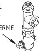
DEBRANCHEZ ET DEBARRASSEZ-VOUS DES ANCIENS TUYAUX A GAZ FLEXIBLES ET LES ANCIENS MATERIAUX DE TRANSITION. REMPLACEZ-LES AVEC UN BRANCHEMENT A GAZ FLEXIBLE APPROUVE CSA (AGA) NEUF ET UN TUYAU DE TRANSITION UL AUSSI APPROUVE.
