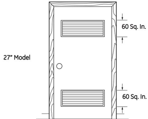
Lorsque les persiennes ou les gonds sont placés sur les ouvertures de la porte, les ouvertures d'air des persiennes ou des gonds doit être égale à 120 Sq. In.
