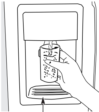
Bac de trop-plein
