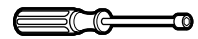
Destornillador de casquillo con cabeza de 5/16" y de 3/4" (se recomienda un casquillo de 6 puntos)
