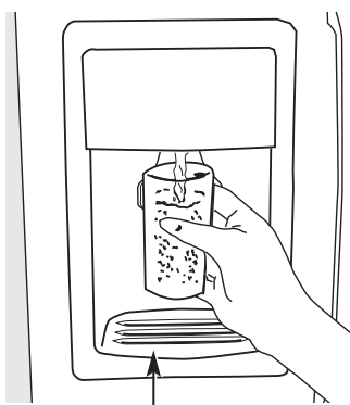
Bac de trop-plein
