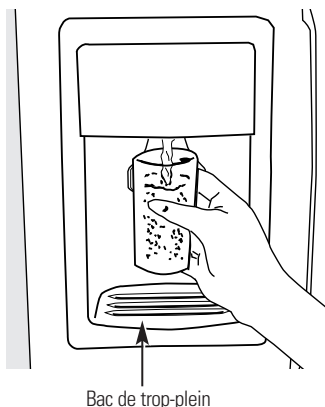
Bac de trop-plein
