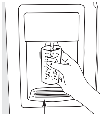
Bac de trop-plein
