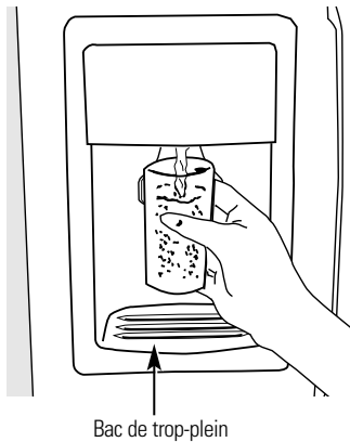
Bac de trop-plein
