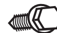
⑮ Vis à tête hexagonale (2) pour le couvercle d'entrée de conduite d'eau (5/8 po)*
