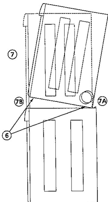
8. Insérez les 2 vis longues fournies dans l'ensemble à travers les trous du panneau avant de la sécheuse et installez-les dans les supports situés à l'avant.
