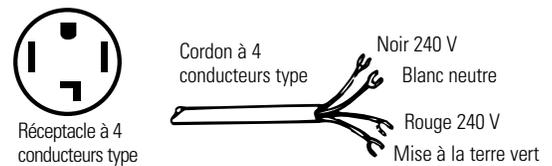
4. Faites passer un cordon d'alimentation en cuivre de norme minimum UL 30A, 240V, 4#10 AWG par le réducteur de tension.
