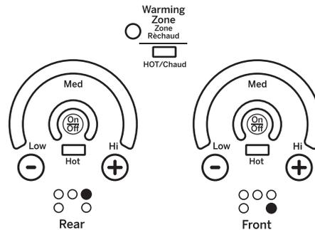
La **ZONE DE RÉCHAUFFAGE**, située au centre arrière de la surface vitrée, gardera la nourriture chaude et cuite à une température de service. Commencez toujours avec de la nourriture chaude. Ne pas utiliser cette option pour chauffer de la nourriture froide. Placer des aliments non cuits ou froids sur la **ZONE DE RÉCHAUFFAGE** peut entraîner des maladies d'origine alimentaire.
