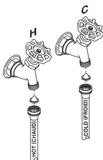
Vérifiez l'absence de fuite et de suintement au niveau des raccords de tuyaux. Resserrez si nécessaire.
