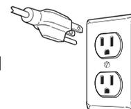
La laveuse doit être correctement mise à la terre conformément aux codes locaux de l'électricité, ou en l'absence de codes locaux, conformément à la dernière édition du NATIONAL ELECTRICAL CODE, ANSI/NFPA NO. 70. Demandez à un électricien agréé de vérifier la connexion si vous n'êtes pas certain que la laveuse est correctement mise à la terre.
