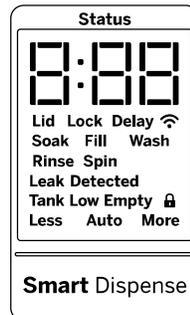
Si l'on souhaite sélectionner manuellement la quantité de détergent pour une brassée particulière, il s'agit de presser le bouton **Select** sur le panneau de commande **Smart Dispense** (distribution intelligente) pour choisir entre **Less** (moins) ou **More** (plus) de détergent. **Less** (moins) va fournir moins de détergent que **Auto** et **More** (plus) en fournira plus que **Auto**.
