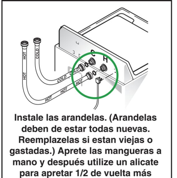
Instale las arandelas. (Arandelas deben de estar todas nuevas. Reemplazelas si estan viejas o gastadas.) Aprete las mangueras a mano y después utilice un alicate para apretar 1/2 de vuelta más
