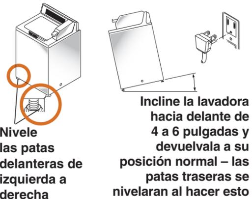
Nivele las patas delanteras de izquierda a derecha
