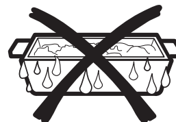
Séchez les contenants pour qu'ils n'induisent pas le capteur en erreur.
