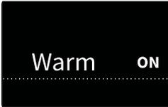
Ce mode vous permet de garder les aliments cuits au chaud. La température de ce programme peut être réglée de 140 °F (60 °C) à 210 °F (98 °C), et Cooking Time peut être réglé de 0 minute à 3 heures. Le Cooking Time recommandé est de 30 minutes.
